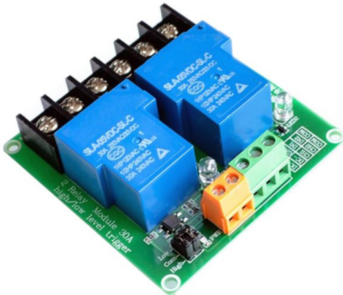
Modulo dotato di 2 relè di potenza che permette di attivare/disattivare il carico ad essi collegato con una corrente massima di 30 A (250 VAC/30 VDC). Dispone di ingressi optoisolati, LED di stato e jumper per selezionare il tipo di ingresso (livello alto o basso). Può essere controllato direttamente tramite Raspberry, Arduino, Fishino o altro microcontrollore. Per il controllo del modulo è necessaria una tensione di alimentazione di 5 VDC e 3,3/5 VDC per la logica di controllo (IN1 e IN2).
