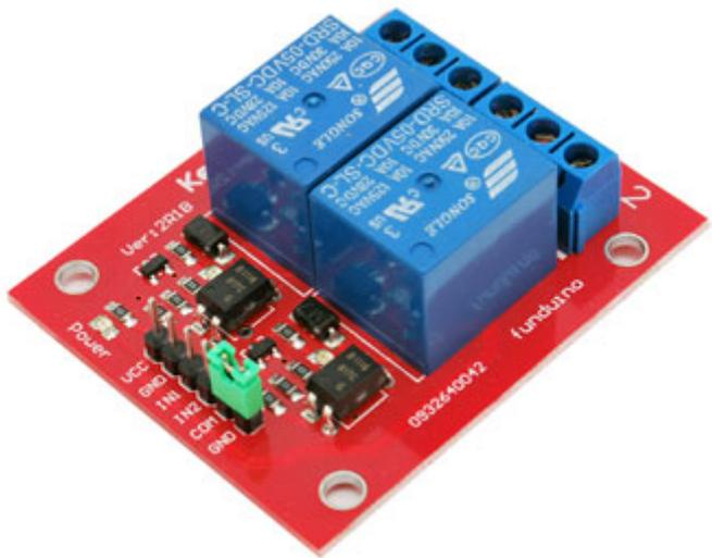
Modulo con 2 Relè in grado di attivare o disattivare carichi fino a 240V/10A. Grazie agli ingressi optoisolati, garantisce un'elevata protezione contro le interferenze elettriche, mentre i LED di stato facilitano il monitoraggio dell'attività del relè. Alimentato a 5 Vdc, presenta contatti di uscita N.A. – Comune – N.C. con una portata dei contatti di 10A 250Vac – 10A 30Vdc. Le dimensioni compatte (55,15x45,68x19 mm) lo rendono ideale per una vasta gamma di applicazioni.
