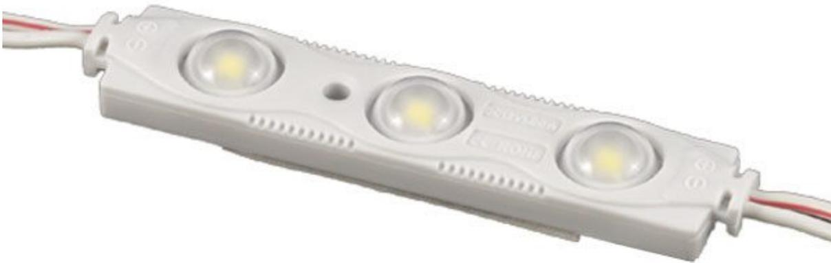
Modulo in ABS con 3 LED bianchi ad alta luminosità, lenti che permettono un'emissione di 160° della luce, alimentazione 12 VDC, potenza: 1,2 watt, flusso luminoso: 105 Lumen, grado di protezione: IP67, vita media: 50.000 ore. Può essere fissato tramite l'adesivo 3M presente nella base o tramite una vite. Dimensioni (mm): 72x16x5,4. Può essere utilizzato in moltissimi modi, ad esempio per realizzare lettere e numeri per pannelli pubblicitari, come illuminazione di prodotti nelle vetrine, ecc.
