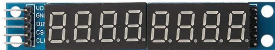
Modulo con 8 display a LED rossi da 7 segmenti e gestito dall'integrato MAX7219. Può essere controllato tramite Arduino o altro microcontrollore e possono essere collegati in cascata più moduli. Alimentazione: 5 VDC
