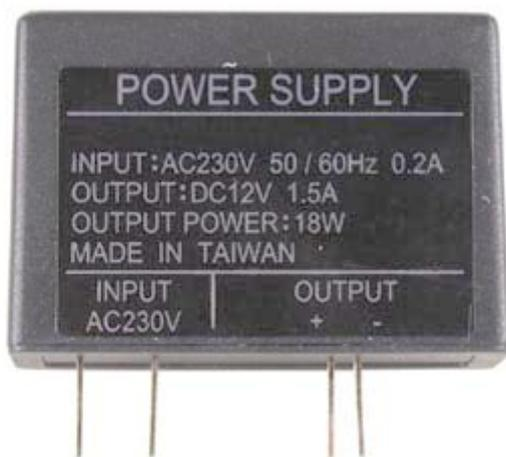
Compatto alimentatore da circuito stampato di tipo switching in grado di erogare una tensione stabilizzata di 12 volt con una corrente massima di 1,5A. Dispone di protezione sia da eventuali corto circuiti in uscita che da sovratemperatura.
