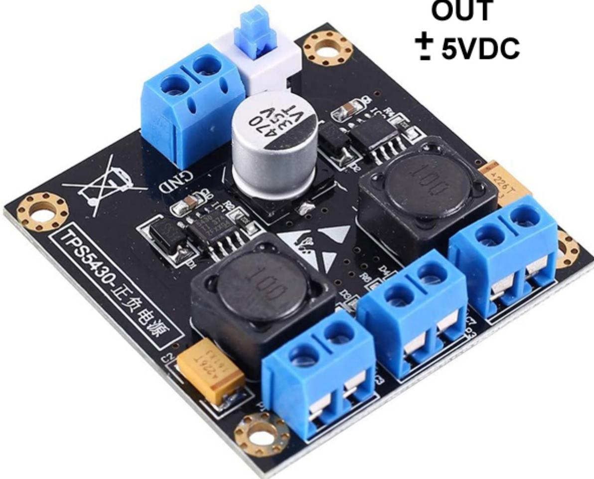
Convertitore DC/DC switching di tipo Step-Down, dalle dimensioni particolarmente ridotte (50x50x18 mm), in grado di convertire una tensione di ingresso compresa tra 6 e 28 VDC in una tensione di uscita duale (-5VDC e +5VDC). Dispone di interruttore on/off, LED di stato, morsettiere a vite per alimentazione d'ingresso e uscita, basso ripple, basso consumo e alta efficienza.
