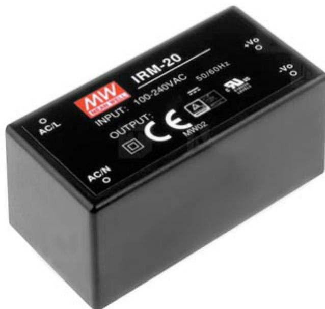
Piccolo modulo alimentatore Mean Well con tensione di ingresso compresa tra 120 e 370 Vac, tensione di uscita 12 Vdc e 20 watt di potenza. Dispone di protezione da cortocircuito, sovraccarico e sovratensione. Isolamento Classe II, consumo senza carico inferiore a 0,1 W.
