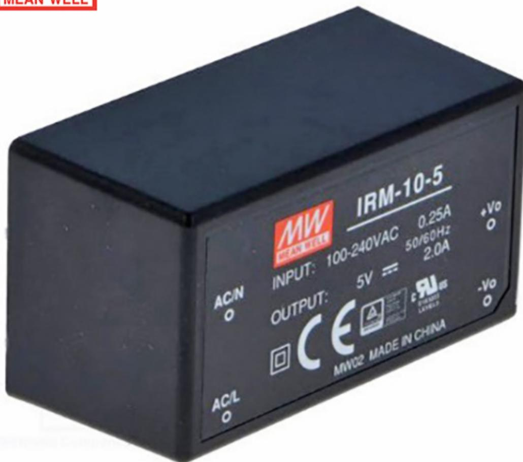
Piccolo modulo alimentatore Mean Well con tensione di ingresso da 85 ~ 264 Vac e 120 ~ 370 Vdc, tensione di uscita 5 Vdc e 10 watt di potenza. Dispone di protezione da cortocircuito, sovraccarico e sovratensione. Isolamento Classe II, consumo senza carico inferiore a 0,1 W.
