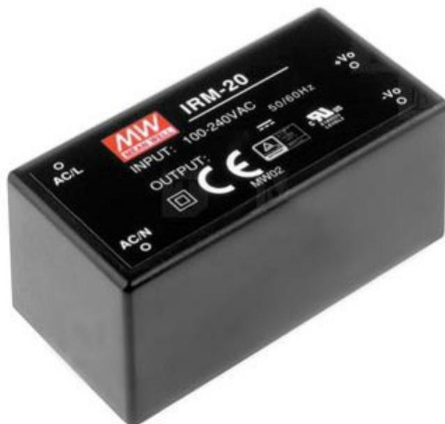
Piccolo modulo alimentatore Mean Well con tensione di ingresso compresa tra 120 e 370 Vac, tensione di uscita 5 Vdc e 20 watt di potenza. Dispone di protezione da cortocircuito, sovraccarico e sovratensione. Isolamento Classe II, consumo senza carico inferiore a 0,1 W.
