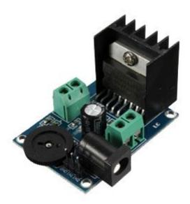
Basato sul chip TDA7297, questo compatto amplificatore stereo è in grado di erogare una potenza massima 15 W su 4-8 ohm. Dispone di potenziometro per la regolazione del volume direttamente sulla scheda. Alimentazione: da 6 Vdc a 18 Vdc, potenza di uscita: 2x15 watt, dimensioni (mm): 53x33x28.Particolarmente indicato per essere utilizzato con piccoli lettori MP3.
