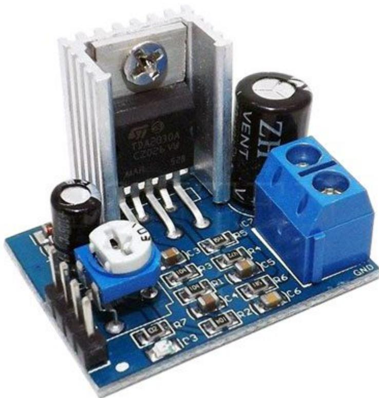
Amplificatore audio basato sul chip TDA2030A. È in grado di erogare una potenza massima 18 watt su 8 ohm. Dispone di trimmer da 10 kohm per la regolazione del volume direttamente sulla scheda. Alimentazione: da 6 a 12 VDC, corrente max. 3 A, potenza di uscita: 18 watt, dimensioni (mm): 32,5x26,5x24,5. Particolarmente indicato per essere utilizzato con piccoli lettori MP3.
