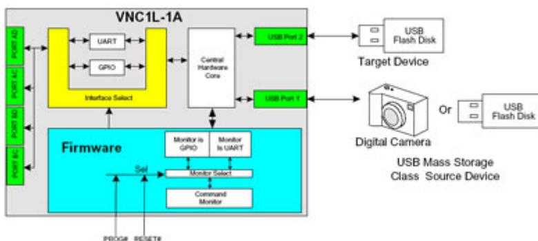
Caratteristiche tecniche: • Due connettori USB tipo "A" per collegare rispettivamente una fotocamera digitale e una Flash Drive USB
