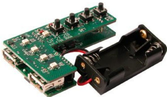
VF2F2B è un dispositivo basato sul chip VNC1L per applicazioni stand-alone. VF2F2B permette di trasferire le fotografie direttamente da una fotocamera digitale ad una Pen drive USB. Il modulo VF2F2B vi permette di scaricare, senza il PC e un lettore di memory card, le fotografie dalla vostra fotocamera digitale direttamente su di una Pen disk USB, il tutto premendo semplicemente un pulsante. Il dispositivo VF2F2B è alimentato con due pile alcaline ministilo AAA.
