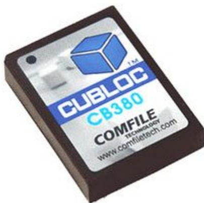
Modulo della famiglia Cubloc basato sul microcontrollore Atmel Atmega2561, in case a 64 pin. Utilizza come linguaggio di programmazione il Basic e la logica Ladder (Multi-tasking). Il Cubloc CB380 è dotato di una memoria programma Flash da 200 kB, una EEprom da 4 kB, 49 I/O configurabili ed una velocità di esecuzione di 36.000 istruzioni al secondo. Per eseguire la programmazione del modulo è disponibile il prodotto 8150-STUDYBOARD (disponibile separatamente).
