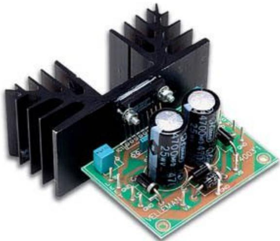
Questo piccolo ma potente stadio finale BF è in grado di erogare una potenza di 2 x 30 W musicali (2 x 15 W rms su 4 Ohm e 2 x 10 W rms su 8 Ohm). Il circuito integrato è completamente protetto da sovraccarichi e cortocircuiti. Il modulo dispone anche di uno stadio raddrizzatore e di filtro per cui, per alimentare il dispositivo è sufficiente utilizzare un trasformatore con secondario a 2 x 12 Vac.
