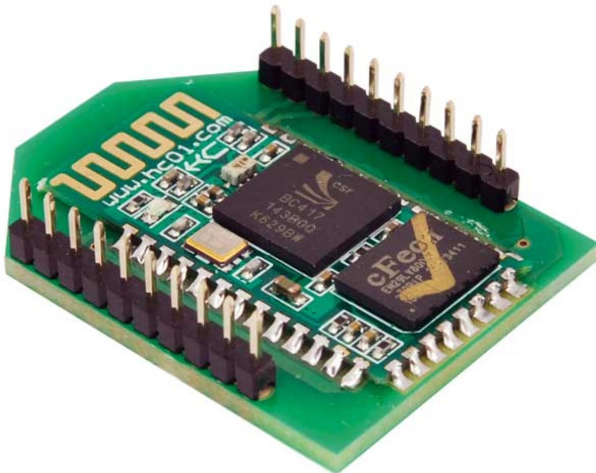
Breakout board compatibile con il formato XBee e dotata del modulo Bluetooth HC-05. È particolarmente indicata per essere utilizzata con lo “Shield Base per Bluetooth” (non compreso – vedere prodotti correlati) appositamente progettato per accogliere tre diversi tipi di moduli Bluetooth (HC-05, BLECC2541, BLE40). Dimensioni breakout board con modulo bluetooth (mm): 33x25x10. **N.B.** lo “Shield Base per Bluetooth” non è compreso, vedere prodotti correlati.
