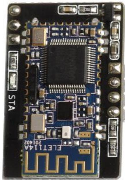
Installato sull'mBot (Educational Robot Kit), questo modulo bluetooth, permette di controllarlo in modalità wireless.
