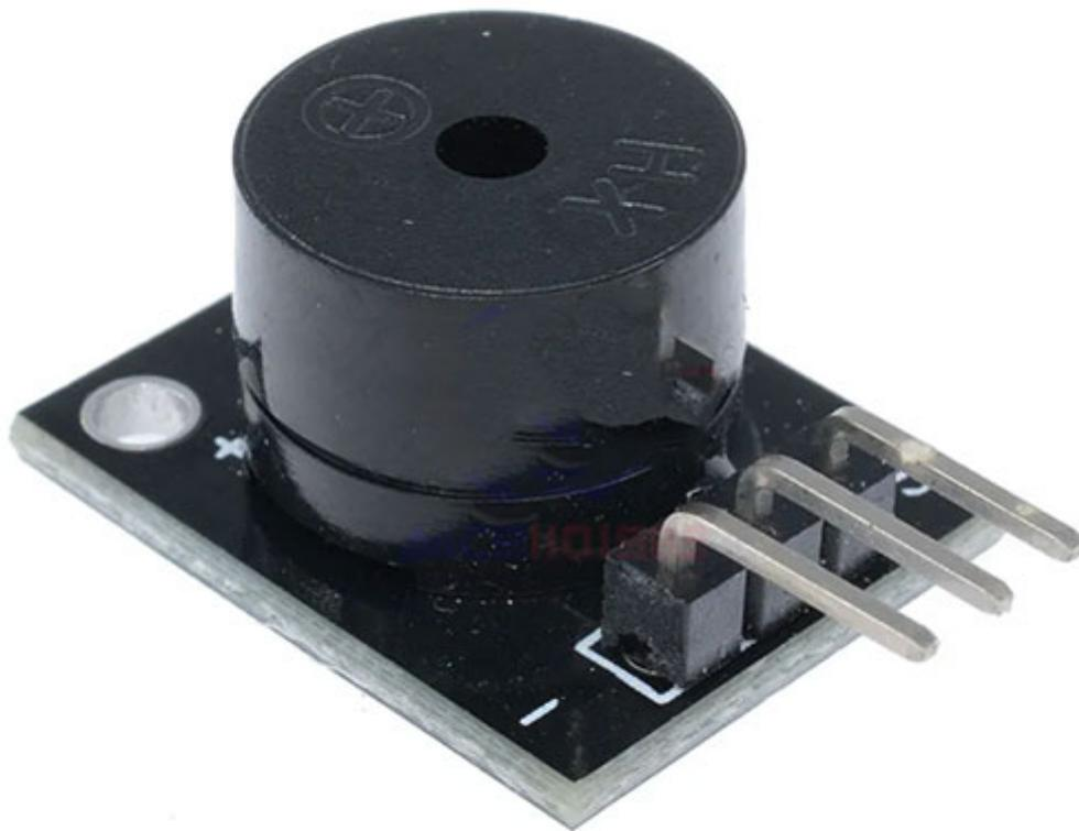
Modulo buzzer attivo operante in un range di tensione compreso tra 3,5V e 5,5V. Con una corrente massima di 30mA a 5VDC, assicura un consumo contenuto di energia durante il suo funzionamento. La sua frequenza di risonanza di 2500Hz  $\pm$  300Hz garantisce una riproduzione sonora chiara e udibile. Ad una distanza di soli 10cm, offre un livello minimo di output sonoro di 85dB, assicurando un segnale audio forte e facilmente distinguibile.
