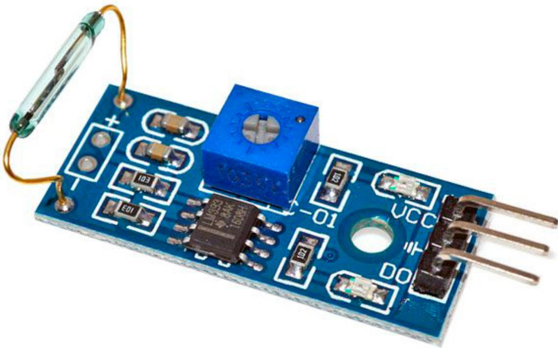
Piccolo modulo basato sul chip LM393 e dotato di contatto Reed (singolo contatto normalmente aperto), trimmer per la regolazione della sensibilità, LED di stato per alimentazione e segnale di uscita. Permette di ottenere un segnale digitale in uscita a seconda se il contatto Reed è chiuso o aperto. Basta avvicinare, ad una distanza massima di 1,5 cm, un magnete per chiudere il contatto. Può essere utilizzato con Arduino, Fishino o altri microcontrollori.
