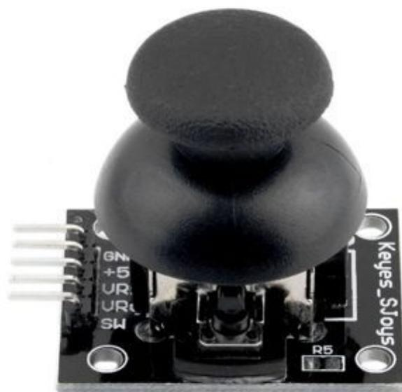
Piccola scheda con joystick da c.s. molto simile a quello utilizzato nel controller della PS2 (PlayStation 2). I movimenti direzionali (su, giù, destra e sinistra) sono ottenuti dalla variazione resistiva, effettuata tramite due potenziometri da 10 kohm, uno per ciascun asse. Dispone inoltre di un pulsante che si attiva quando il joystick viene premuto verso il basso. Quando il joystick non
