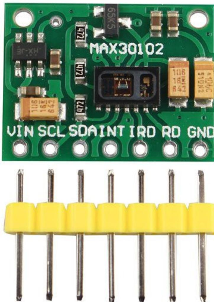
Piccolo modulo I2C basato sul sensore per [pulsossimetria](#) MAX30102 in grado di misurare, in maniera non invasiva, la quantità di emoglobina legata nel sangue e la frequenza cardiaca. È composto da due diodi LED (uno a luce rossa da 660 nm e l'altro a infrarossi da 880 nm), un fotodiodo che riceve la luce riflessa dai tessuti per determinare la percentuale di emoglobina saturata dall'ossigeno.
