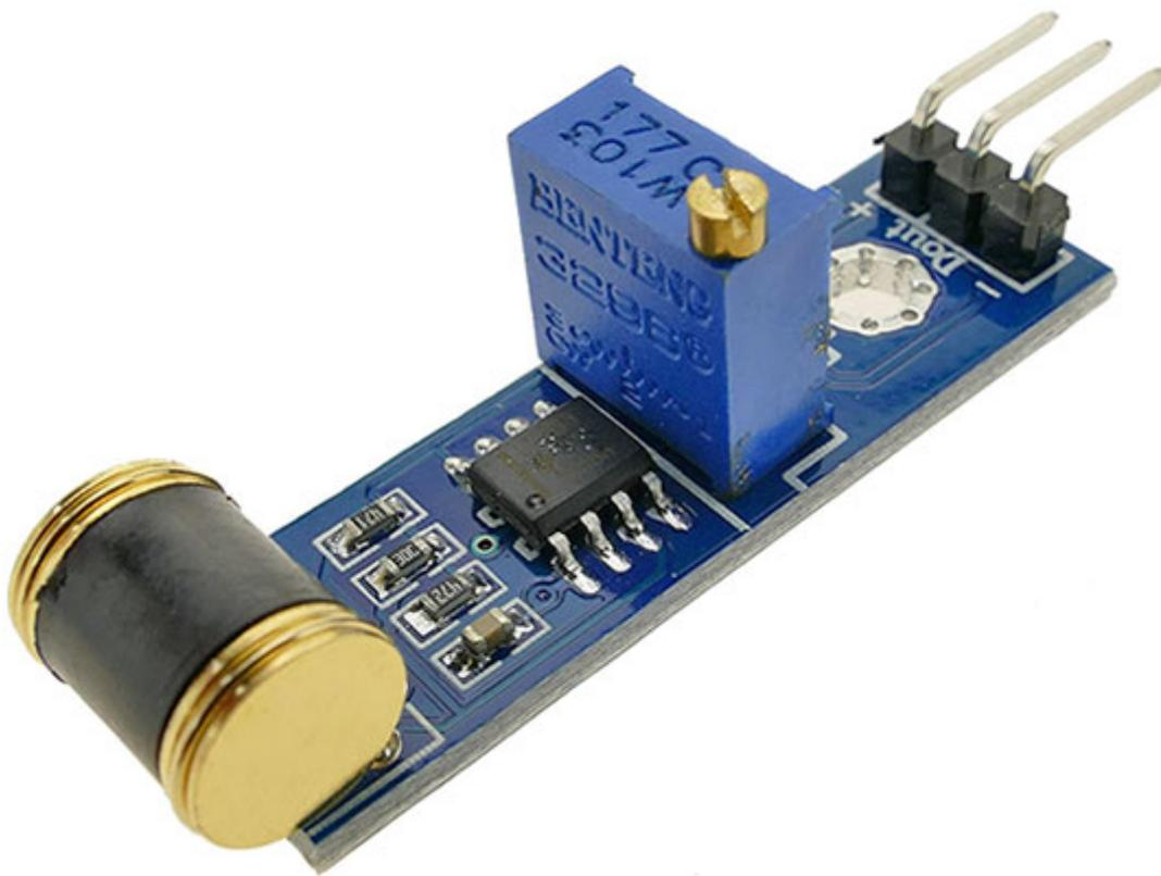
Modulo con sensore di vibrazione 801S ad alta sensibilità, con uscita digitale in grado di essere interfacciata con segnali TTL. Il sensore rileva anche piccole vibrazioni con la principale caratteristica di non aver limiti di direzionalità ma lavorando a 360 gradi. Un comparatore interno permette di regolare, tramite trimmer, la soglia di sensibilità.
