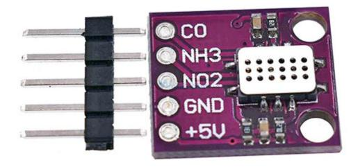
Modulino basato sul sensore per la qualità dell'aria MICS-6814 della Amphenol SGX Sensortech. Il MiCS-6814 integra in un unico package tre sensori indipendenti (Monossido di carbonio, Diossido di azoto e Ammoniaca). Permette di rilevare i gas di scarico di automobili, industriali e agricoli.
