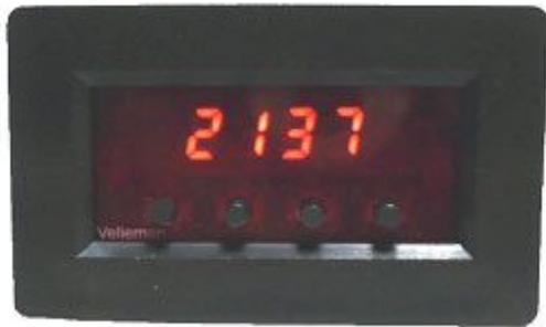
Compatto contatore digitale in grado di eseguire un conteggio incrementale e decrementale ed attivare un'uscita quando viene raggiunto il valore preimpostato. Funzione "auto reset". Due ingressi: conteggio avanti o indietro.
