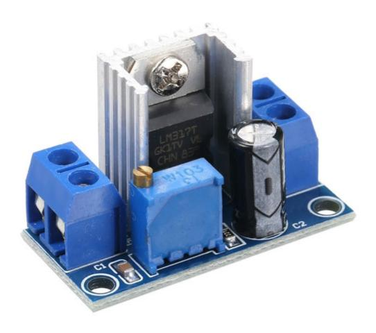
Compatto modulo DC/DC Step-Down basato sul regolatore di tensione LM317. È in grado di convertire una tensione continua compresa tra 4,2 e 40 volt in una tensione di uscita da 1,2 a 37 volt (regolabile tramite trimmer). La massima corrente disponibile è di circa 1,5 A. Dimensioni (mm): 35x22x17.
