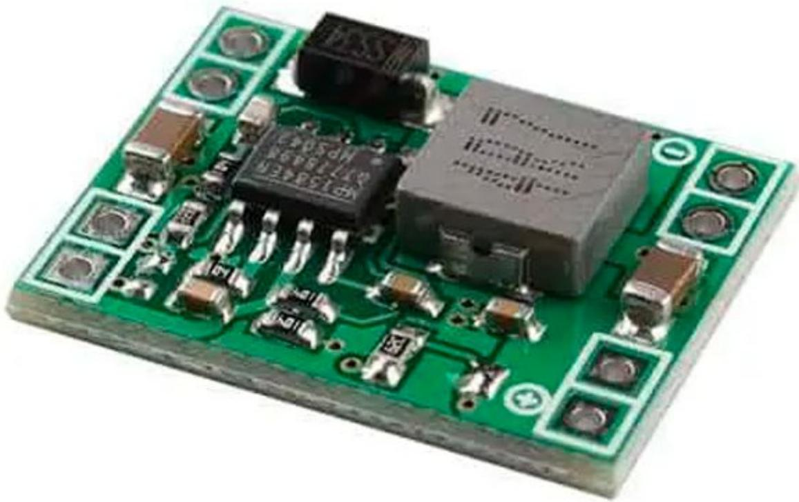
Convertitore DC/DC Step-Down, dalle dimensioni particolarmente ridotte (22,3x17x4,4 mm), in grado di convertire una te
