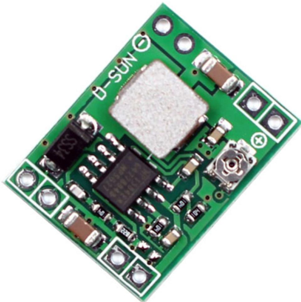
Convertitore DC/DC Step-Down, dalle dimensioni particolarmente ridotte (22,3x17x4,4 mm), in grado di convertire una te
