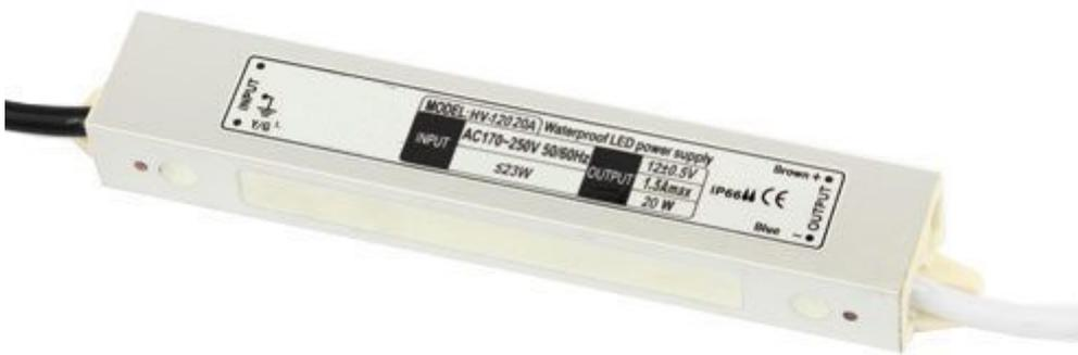
Alimentatore a corrente costante per LED dotato di protezione contro i cortocircuiti, i sovraccarichi e le sovratensioni. Tensione di ingresso: 220 Vac, tensione di uscita: 12 Vdc, potenza: 20 watt, grado di protezione: IP67.
