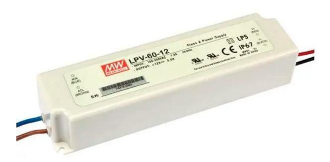
Alimentatore a tensione costante per LED dotato di protezione contro i cortocircuiti, i sovraccarichi e le sovratensioni. Tensione di ingresso: 220 Vac, tensione di uscita: 12 Vdc, potenza: 60 watt, grado di protezione: IP67.
