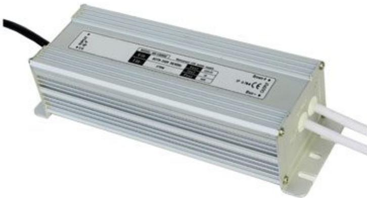
Alimentatore a corrente costante per LED dotato di protezione contro i cortocircuiti, i sovraccarichi e le sovratensioni. Tensione di ingresso: 220 Vac, tensione di uscita: 12 Vdc, potenza: 60 watt, grado di protezione: IP67.
