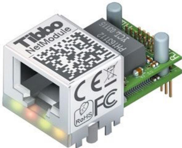
Modulo di conversione Seriale/Ethernet composto dall'EM203 (con controller DM9000B) e dal connettore Ethernet 10/100BaseT. Dispone di quattro led di segnalazione, un uscita seriale TTL full-duplex e half-duplex con velocità di trasmissione sino a 115 Kbps. Compatibile con tutti gli altri moduli Tibbo e con i relativi software applicativi. Porta Ethernet compatibile 100/10BaseT. La confezione comprende il modulo e un mini CD contenente il software [Tibbo Device Server Toolkit](#).
