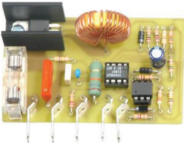
Modulo di potenza da utilizzare con la scheda base del sistema di controllo luci con PC cod. FT520B. Completa di fotoaccoppiatore che garantisce un isolamento galvanico tra la sezione alimentata a 220 volt e quella di controllo collegata al PC. E' in grado di controllare carichi con potenza massima di 800-1.000 watt.
