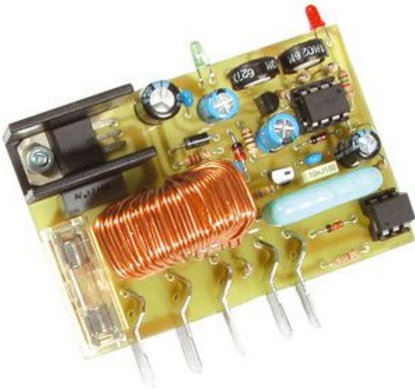
Modulo dimmer di potenza realizzato con un microcontrollore Microchip. Compatibile sia elettricamente che meccanicamente con il kit FT520AK.
