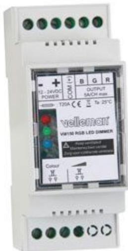
Permette di controllare, tramite pulsante, la selezione del colore e la regolazione della luminosità di strip a LED RGB da 12/24 Vdc e strip a LED singolo colore da 12/24 Vdc. Possibilità di collegare più pulsanti in parallelo. Dispone di uscite di potenza (5A /canale) e protezione da cortocircuito. Alimentazione: da 12 a 24 Vdc, uscita: 5 A. È possibile incrementare la potenza d'uscita utilizzando il prodotto VM169.
