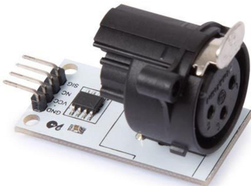
Basato sul chip MAX-485 (o SN75156) e dotato di connettore DMX XLR maschio a 3 pin, questo modulo consente di controllare tramite Arduino dispositivi funzionanti con lo standard DMX a 3 pin. Alimentazione: 5 VDC, impedenza: 100 Ohm, dimensioni (mm): 40x20x30, peso: 10 grammi.
