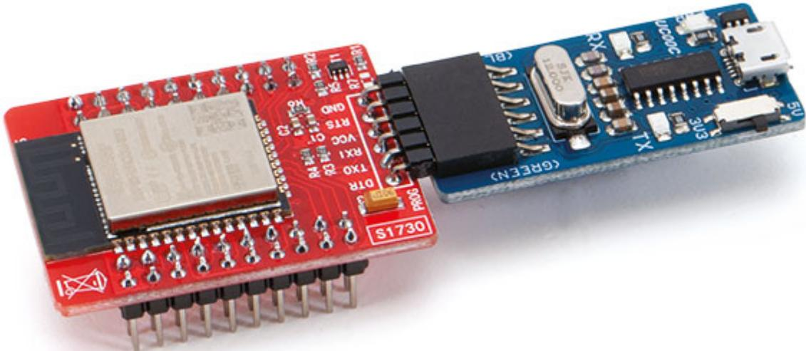
Il modulo 1686-USBTOUART, **che trovi nei prodotti correlati**, dispone di un'interfaccia USB che nei Personal Computer con sistema operativo Windows, previa installazione dei driver forniti, viene associata a una porta COM virtuale e può quindi essere gestita nell'IDE Arduino con facilità, semplicemente impartendo, dal menù Strumenti, il comando Porta Seriale, quindi scegliendo nel sottomenù la porta creata dai driver stessi.[/caption]
