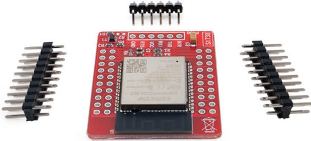
Il modulo viene fornito con la componentistica in SMD già montata. L'unica operazione da eseguire prima di iniziare a utilizzarlo, è quella di saldare i 2 Pin strip 2x10 con passo da 2.54mm e il pin strip maschio a 6 vie sulle rispettive piazzole.[/caption]
