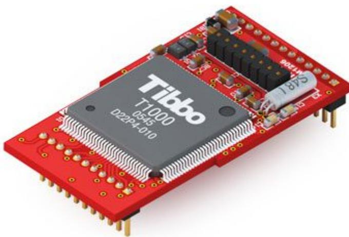
Basato sul microcontrollore ad alte prestazioni T1000 ASIC a 88 MHz, il modulo TIBBO EM1206, dispone di porta Ethernet 10/100BaseT auto-MDIX, quattro porte seriali ad alta velocità, memoria flash da 1024 kB, 2 kB di EEPROM, 17 linee I/O (di cui 8 linee di interrupt) e RTC. Completamente supportato dal software TIDE (vedi "Tibbo BASIC Programming Guide"), l'EM1206 è in grado di gestire la comunicazioni Wi-Fi (questo richiede il modulo aggiuntivo GA1000), display LCD esterno, tastiera e buzzer.
