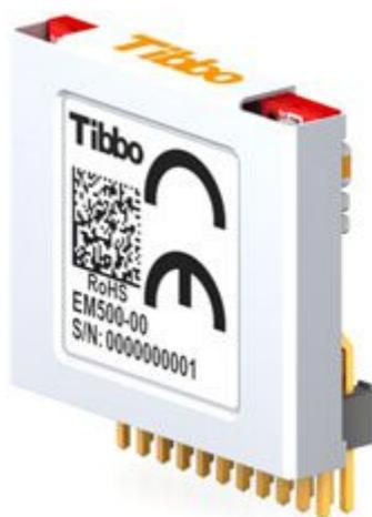
Basato sulla seconda generazione di microcontrollori ASIC T2000, il modulo TIBBO EM500, dispone di porta Ethernet 10/100BaseT auto-MDIX (connettore ethernet non compreso), una porta seriale, 8 linee di I / O, 512 kB di memoria flash (192 kB Tios - 320 kB per applicazione) e 200 byte di EEPROM per la memorizzazione dei dati. Completamente supportato dal software TIDE (vedi "TIDE e manuale Tibbo BASIC").
