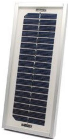
Modulo policristallino da 1,5 watt dotato di telaio in alluminio, protetto da vetro antiurto ad alta resistenza e laminato con EVA e TEDLAR® per evitare formazione di condensa e penetrazione di umidità. Potenza di picco: 1,5 W, tensione nominale: 6 V, tensione al punto di massima potenza: 8,93 V, corrente massima: 0,17 A, dimensioni: 23,5 x 10 x 1,6 cm, peso: 365 g. Particolarmente indicato per hobbisti, piccoli kit dimostrativi per scuole, ecc.
