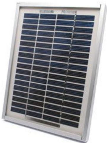
Modulo policristallino da 2,5 watt dotato di telaio in alluminio, protetto da vetro antiurto ad alta resistenza e laminato con EVA e TEDLAR® per evitare formazione di condensa e penetrazione di umidità. Potenza di picco: 2,5 W, tensione nominale: 12 V, tensione al punto di massima potenza: 17,30 V, corrente massima: 0,14 A, dimensioni: 21 x 15,7 x 1,6 cm, peso: 468 g. Particolarmente indicato per hobbisti, piccoli kit dimostrativi per scuole, ecc.
