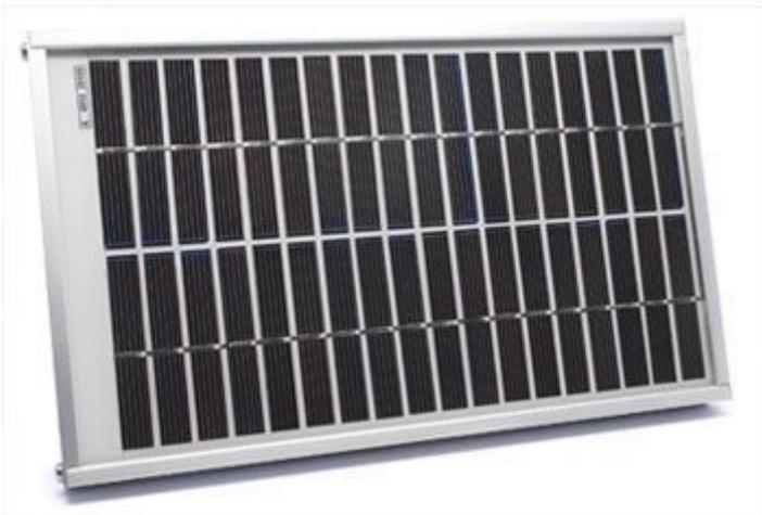
Modulo policristallino da 5 watt dotato di telaio in alluminio anodizzato e protetto da vetro temprato. Potenza di picco: 5 W, tensione nominale: 12 V, tensione al punto di massima potenza: 16,5 V, corrente massima: 0,3 A, dimensioni: 30 x 18,3 x 2,3 cm, peso: 720 g. Particolarmente indicato per hobbisti, piccoli kit dimostrativi per scuole, ecc.
