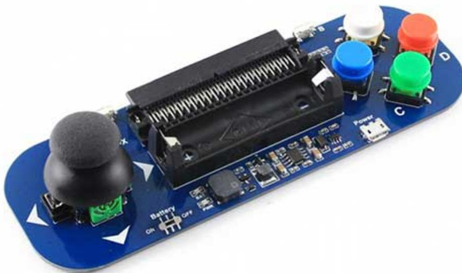
Modulo gamepade estremamente preciso e affidabile in grado di aggiungere controlli arcade alla scheda Micro:bit rendendola una mini console di gioco. Integra un buzzer per la riproduzione di effetti sonori e rumori di sottofondo del gioco. Funziona con una batteria agli Ioni di Litio 14500 (non inclusa), ricaricabile tramite porta USB. Dispone di indicatore dello stato di carica della batteria. **La scheda Micro:bit, il cavo USB e la batteria non sono inclusi.**
