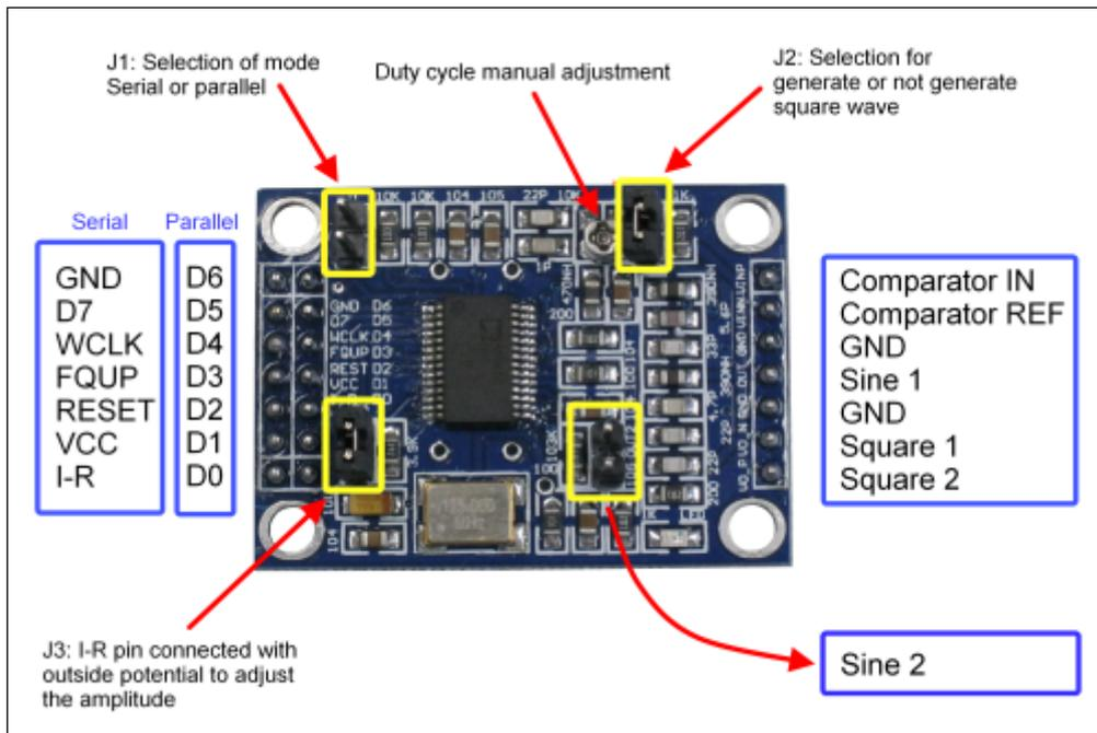
Modulo DDS (**Direct Digital Synthesis**) basato sull'integrato AD9850 della Analog Devices. È in grado di generare forme d'onda con frequenza fino a 40 MHz. Dispone di due uscite ad onda sinusoidale (una delle quali attraverso il filtro passa basso che migliora il rapporto S/N della forma d'onda), due uscite ad onda quadra, regolazione del duty cycle. Può essere controllato tramite comunicazione seriale o parallela. Dimensioni (mm): 42 x 30.
