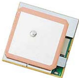
Basato sul chipset SiRF Start IV a 48 canali, è caratterizzato da una sensibilità di -163dBm, basso consumo e dimensioni particolarmente ridotte (30x30x10,5 mm). Particolarmente adatto per applicazioni che richiedono pochissimo ingombro.
