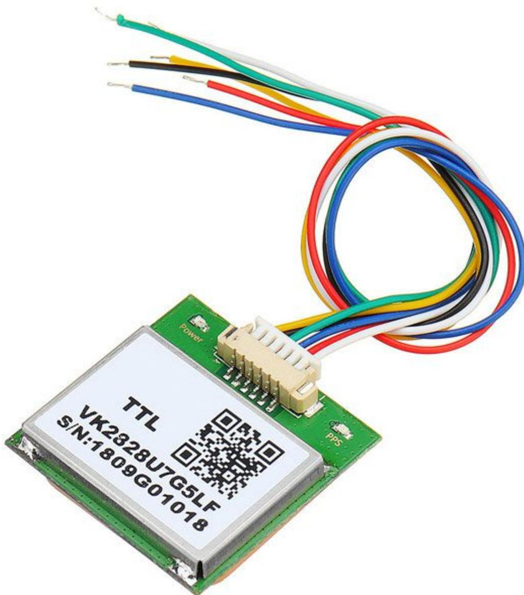
Modulo ricevitore GPS a 56 canali con chipset UBX-G7020-KT, completo di antenna in ceramica, comunicazione seriale TTL e uscita dati formato NMEA0183 V3.0 (GGA, GSA, GSV, RMC e VTG). Abbinata ad Arduino o Raspberry Pi, permette di conoscere la posizione di un robot (non in luoghi chiusi), di un oggetto oppure può essere impiegato con un controller di volo per multicotteri. Alimentazione: da 3,3 VDC a 5 VDC.
