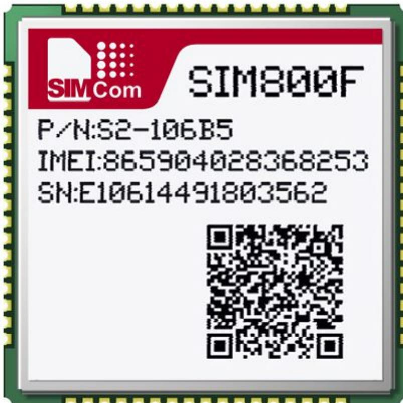
Il SIM800F è un modulo GSM/GPRS Quad-band 850/900/1800/1900 MHz in grado di trasmettere informazioni vocali, SMS e dati a basso consumo energetico.
