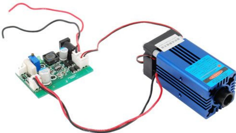
Modulo laser con emissione blu (445 nm) per impieghi industriali rispondente alle norme EN60825-1. Ciascun modulo viene collaudato per 200 ore in emissione continua e viene soggetto a 300 cicli di ON/OFF. Il modulo dispone di ventola per la dissipazione del calore, permettendo al LASER di funzionare in modo continuo. Il modulo richiede una tensione di alimentazione di 12 volt ed una corrente minore di 1 A.
