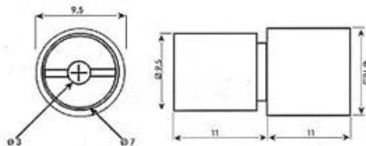
Modulo laser da 2,5 mW di classe 3R completo di circuito automatico di regolazione in corrente inserito all'interno del piccolo contenitore metallico che funge anche da dissipatore. Contenuta divergenza del fascio, ottima visibilità.
