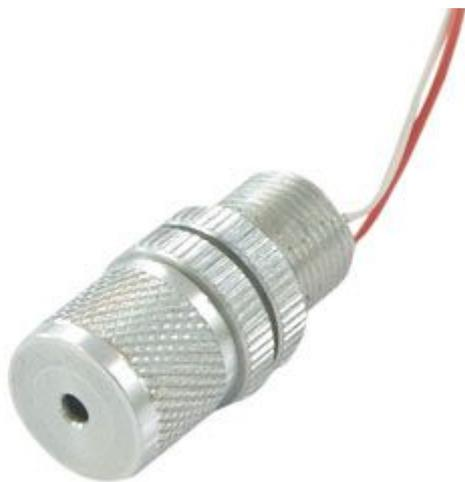
Moduli laser con emissione rossa (640 nm) per impieghi industriali rispondente alle norme EN60825-1. Disponibili in contenitore alluminio anodizzato elettricamente isolato. Il modulo richiede una tensione di alimentazione comprese tra 2,5 e 5 volt ed una corrente di 40 mA circa. **ATTENZIONE:** il modulo viene venduto senza meccanica portante (completa di ottica diffrattiva), acquistabile separatamente codice 8100-PLCROCE oppure 8100-PLLIN.
