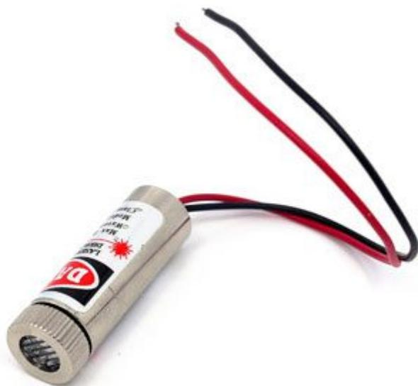
Modulo laser con diodo a semiconduttore ed emissione a 650 nanometri. Dispone di una lente acrilica che permette di proiettare una linea. Alimentazione: da 4 Vdc a 6 Vdc.
