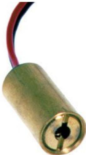
Modulo laser allo stato solido comprendente un diodo a semiconduttore con emissione a 670 nanometri. Il dispositivo integra un collimatore con lente in plastica e un circuito elettronico per il controllo della potenza emessa e per la stabilizzazione della tensione di alimentazione che permette di alimentare il modulo con una tensione continua compresa tra 3 e 6 volt. Il diametro del modulo è di appena 9 millimetri con una lunghezza di 20 mm.
